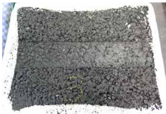
AB 8 med 30% fræst materiale efter sporkøring
