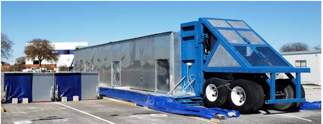
Her ser man APT-maskinen der påfører og kontrollerer hjullasten med temperaturstyret kammer placeret over en af testsektionerne
