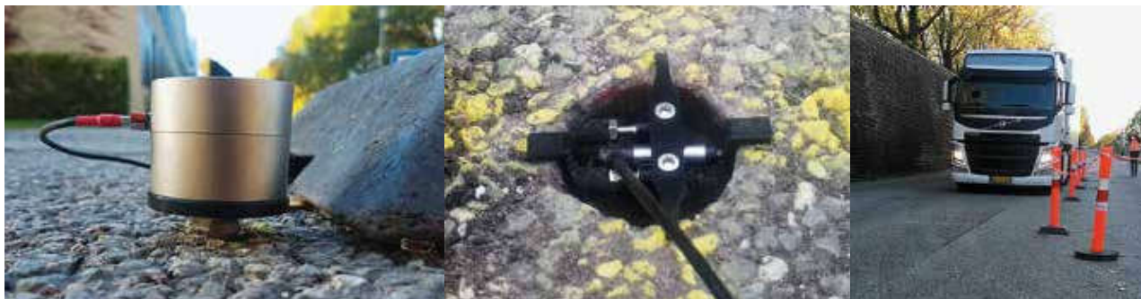
Figur 4: Illustrationer fra tidligere forsøg med sensorer monteret på vejen. Fra venstre mod højre ses følgende: Accelerometer, LVDT og Raptor (testkøretøj).
